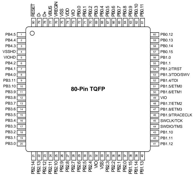
Figure 6.1. SiM3U1x7-GQ Pinout
