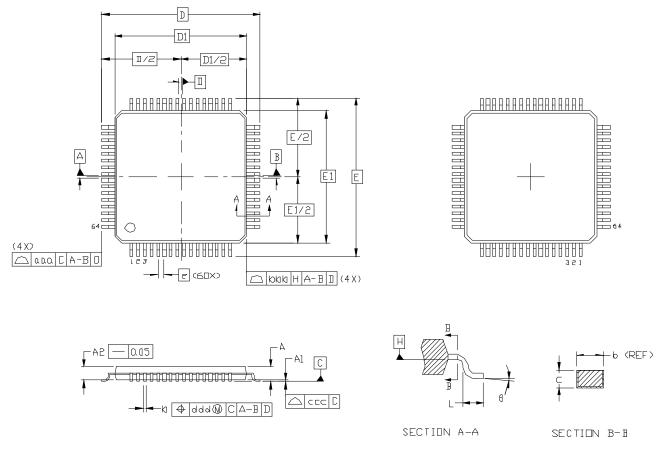
Figure 6.12. TQFP-64 Package Drawing
